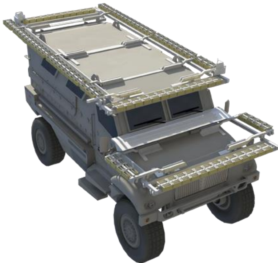
Figur 5. Iron Curtains verkansdelar monterat i ring på ett fordonstak 37
