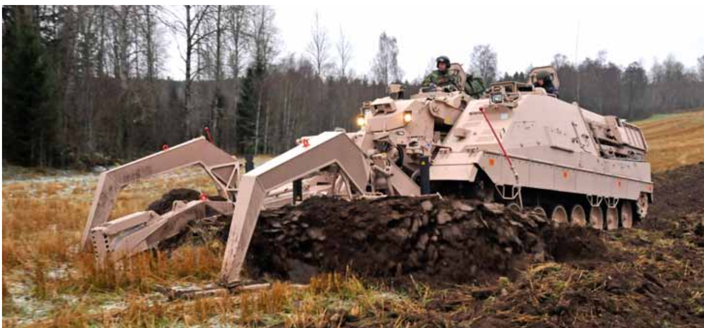
Minbrytning med vagnchefen sittande uppe. Varje arm framför minplogen har spolar för att detonera magnetiska mintändare.
