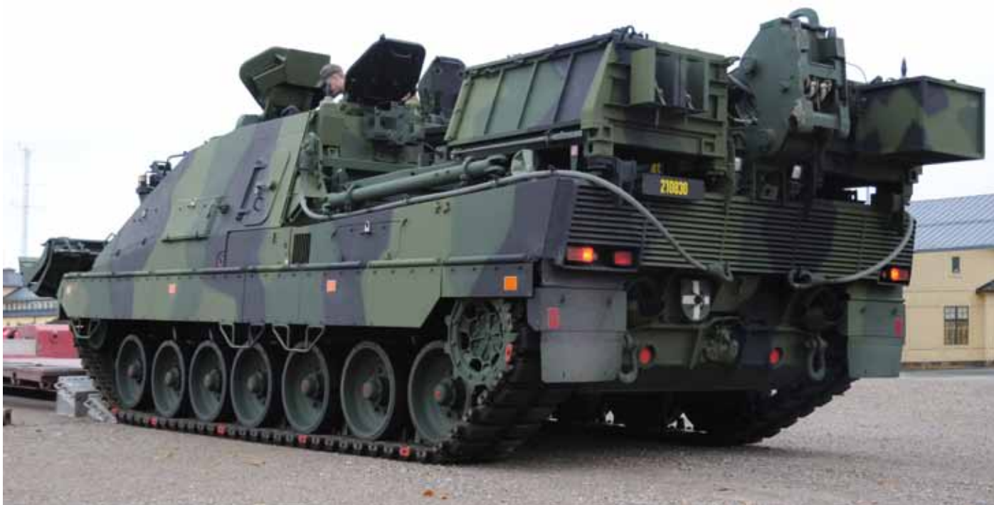
Ingenjörbandvagn precis lossad från transportvagnen i Eksjö. Utöver ordinarie minskydd som finns på stridsvagn 122 B Int finns ett extra IED-skydd monterat vid nedre delen av vagnskroppen.
