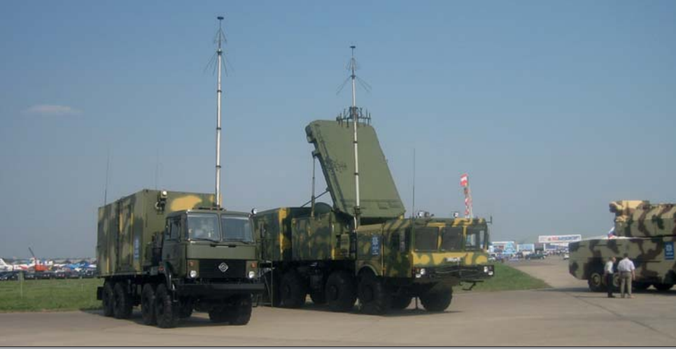
I luftvärnssystemet S-400 ingår såväl mobila ledningsplatser som radarstationer. Radarn har en räckvidd på över 600 km.
