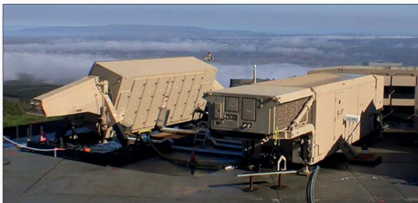
Den amerikanska AN-TPY 2 är ett mobilt avancerat radarsystem för att upptäcka ballistiska missiler i sina banor. För närvarande finns två stationer i östra delen av Medelhavet. Totalt planeras det för 11 stycken system.
