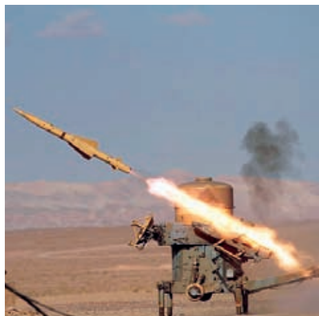
Rapier, draget korträckviddigt lv-system med kommandostyrda robotar. Räckvidd ut till ca 7000 m. Höjdtäckning upp till ca 3000 m.
