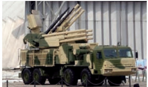
Pantsir-S1. Autonomt med alla delsystem i fordonet.
