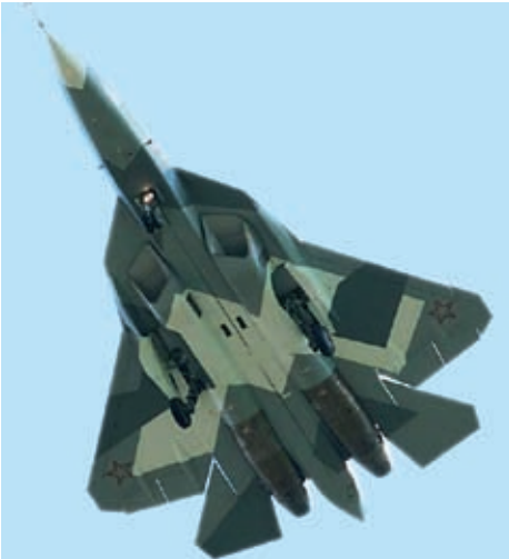
PAK-FA, även benämnd T-50. Flygplanet är delvis byggt av titanlegeringar. Max vapenlast är 7,5 ton.
