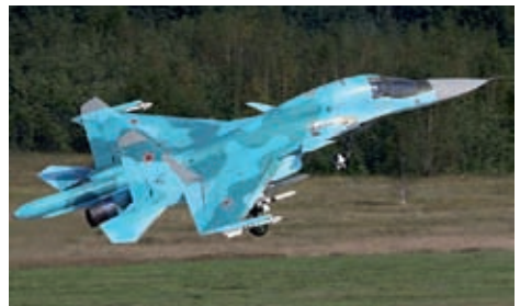
Su-34 är det senaste tillskottet och är en utveckling av Su-24. Tungt attackplan med lång räckvidd och 8 tons vapenlast. Planet har ett litet vilrum/pentry för långa flygningar.
