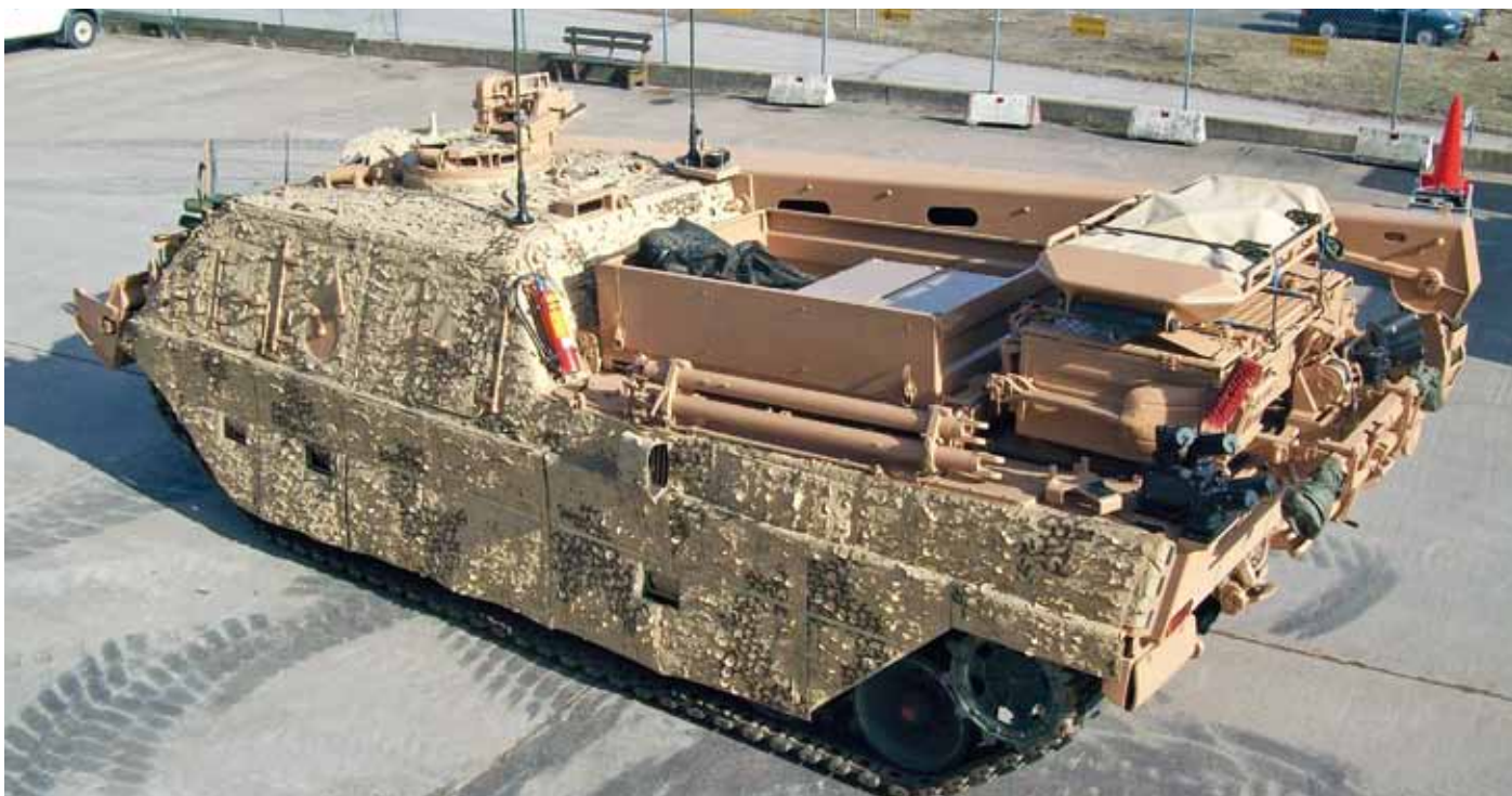
Bärgningsbandvagn 120 med multispektralt maskeringssystem. Vagnens kran kan lyfta 30 ton vilket medger lyft av torn på Strv 122 (vikt 21 ton). Vinschen klarar 100 tons dragkraft. Besättningen består av 3 man. Bakom besättningsutrymmet finns normalt ett motorpaket som reserv (V-12 dieselmotor) men här finns nu ett splitterskyddat förvaringsutrymme.
