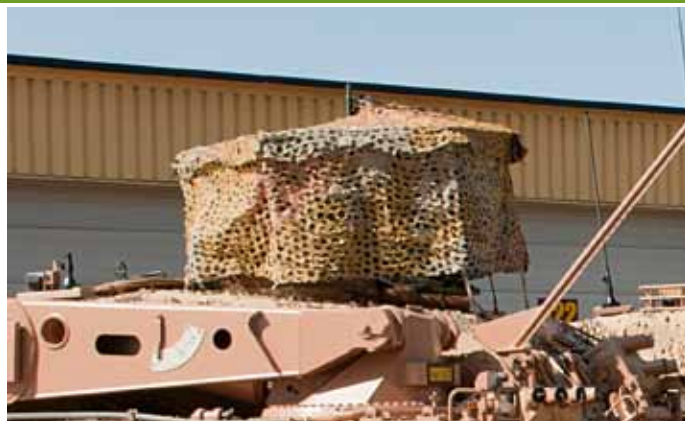
Samtliga Int-vagnar har parasoll för vagnchefsplatsen. Detta skall skydda mot sol och värmeinstrålning, även de nerfällbara gardinerna är skydd mot värme men hindrar även insyn.
