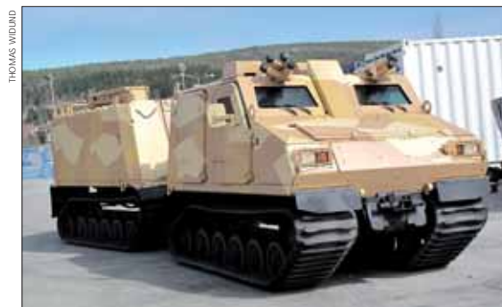
Bandvagn 10 S MKII. Vagnen har sålts till Storbritannien, Nederländerna och Frankrike och används av marininfanteriet i dessa länder. Vagnen är splitterskyddad och tål finkalibrig eld och är amfibisk.
