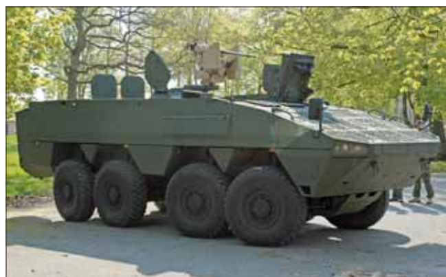
Pansarterrängbil AMV XA 360. Fordonet har en Protector vapenhuv (12.7 mm tung ksp) som innebär att skytten kan sitta inne i det pansarskyddade utrymmet och skjuta utan att exponera sig.
