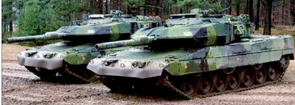
Leopard 2 tillverkades nya för Sverige och infördes under beteckningen Strv 122. Av de 120 beställda och levererade stridsvagnarna har hittills 14 byggts om och förstärkts med minskydd och med ny beteckning strv 122B. Till Leopardssystemet ingår även 14 bärgningsbandvagn 120 byggda på Leopard 2 chassi.
