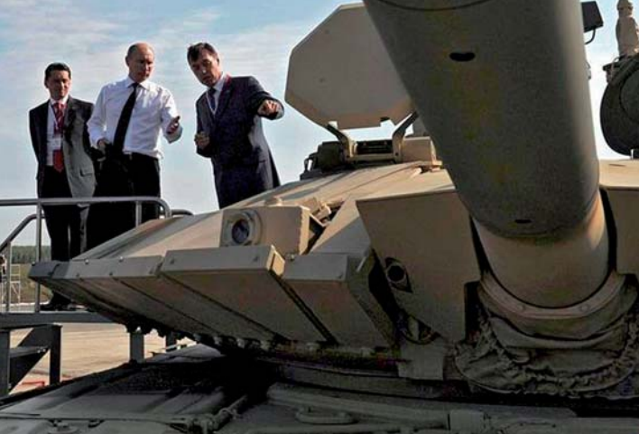
Premiärminister Vladimir Putin visade stort intresse för den senaste modellen av den ryska T-90 stridsvagnen. Det nya tunga reaktiva pansarskyddet syns till vänster om kanonen. En laservarnare är integrerad i skyddsmodulerna.
