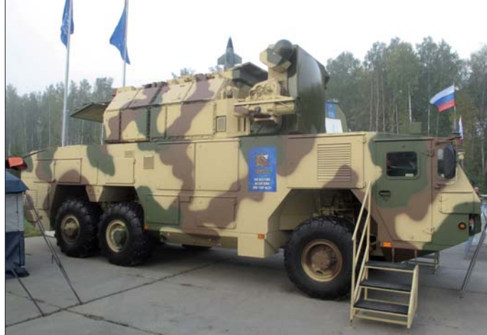
Ryskt luftvärnsrobotsystem Tor M2 som förevisades under mässan. NATO-beteckning är SA-15. Åtta robotar medföljer fordonet varav en syns sticka upp. Belysningsradarn syns till höger uppe på fordonet. En tidigare version av systemet är exporterat till Iran. Iran har de senaste åren desperat försökt att köpa kvalificerade luftvärnsrobotsystem.
