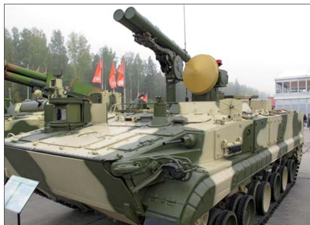
Det fordonsbaserade robotsystemet Khrizantema-S med två robotar i lavetten och ytterligare 15 robotar i chassiet. Till höger om robotrören syns millimetervåggradarn och till vänster värmebildsiktet. Arabisk text inne i fordonet avslöjade att fordonet var tänkt för export till Libyen.
