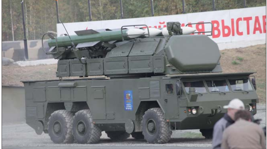
Ett ryskt luftvärnsrobotsystem Buk-M2EK visades upp. Finland köpte i mitten på 1990-talet en föregående version vilken avses ersättas av ett NATO-system (NASAM) 2015. Ovan till höger syns den 8-kantiga belysningsradarn. Höjdtäckningen är satt till 25 000 meter. Venezuela är den senaste nation som fått leverans av det nya systemet.
