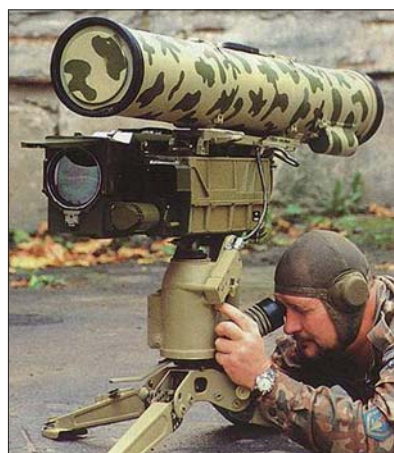
Rysk modern tung pansarvärnsrobot AT-14 som exporterats vidare av Syrien till Hizbollah. Räckvidd dagar 5500 meter och penetrerar upp till 1300 mm pansar. Dessa robotar sattes in i Wadi Saluki mot Israels Merkava Mk III och Mk IV stridsvagnar med framgång.
