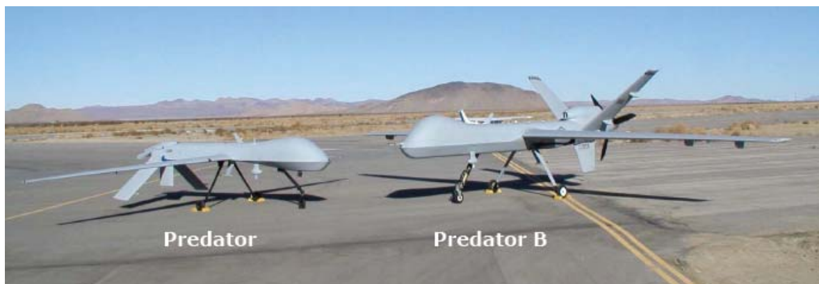
Bild 2. Vid en jämförelse syns att även om de påminner om varandra så är MQ-9 Reaper (Predator B) är ett helt annat system jämfört med den ursprungliga RQ-1/MQ-1 Predator A. Bild via General Atomics.
