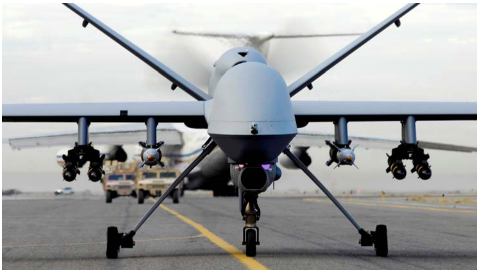
Bild 3. Predator B/MQ-9 Reaper har sedan hösten 2007, deltagit i striderna i Afghanistan. På bilden en MQ-9 Reaper utrustad med fyra Hellfire robotar och två GBU-12 styrda glidbomber. Bild via U.S. Air Force photo, 2 Staff Sgt. Brian Ferguson.
