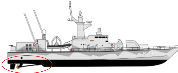
Bild 3.1 HMS Stockholm. Propelleraxel (3 st.) med axelbärare och propeller 29
