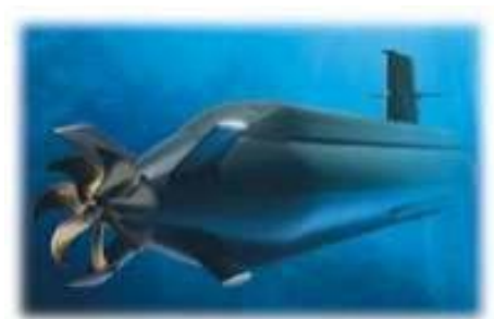
Bild 3.4 Sjubladig fast propeller på ubåt (skiss) 39
