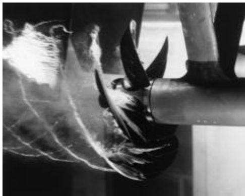
Bild 4.1 Kavitation vid utprovning av en fartygspropeller. Kavitationsblåsorna bildar spiralformade banor som följer strömningslinjerna i vätskan efter propellen. 47
