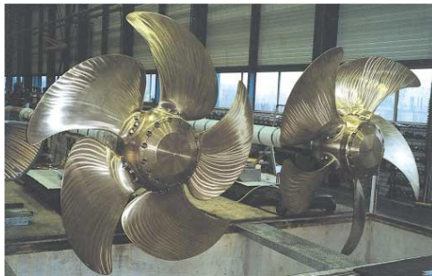
Bild 3.3 Fembladig variabel pitch propeller från Wärtsilä Lips Defence, designad för fregatt 38
