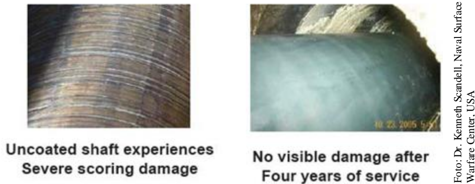
Bild 6.1 Propelleraxel utan och med nanostrukturell ytbeläggning
