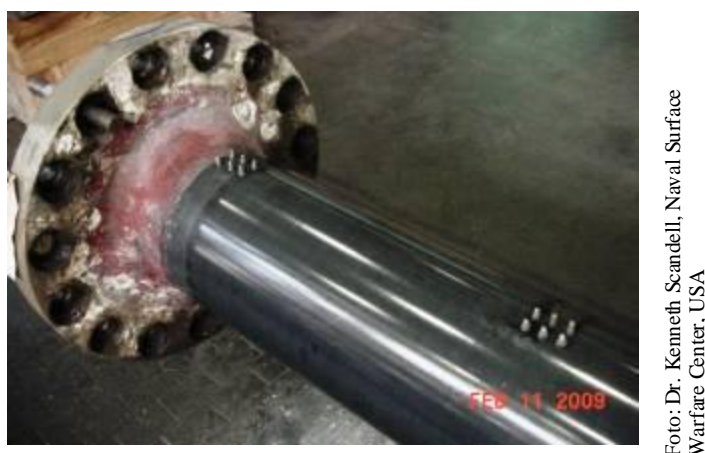
Bild 6.2 Propelleraxel med nanobeläggning. De tolv fästpunkterna är till för att genomföra dragtester i syfte att mäta dragspänning på ytbeläggningen.
