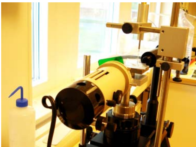
Bild 4.4 Mätutrustning vid FOI för kontroll av vätskedroppars KV på olika ytor. Foto: Hans Kariis/FOI
