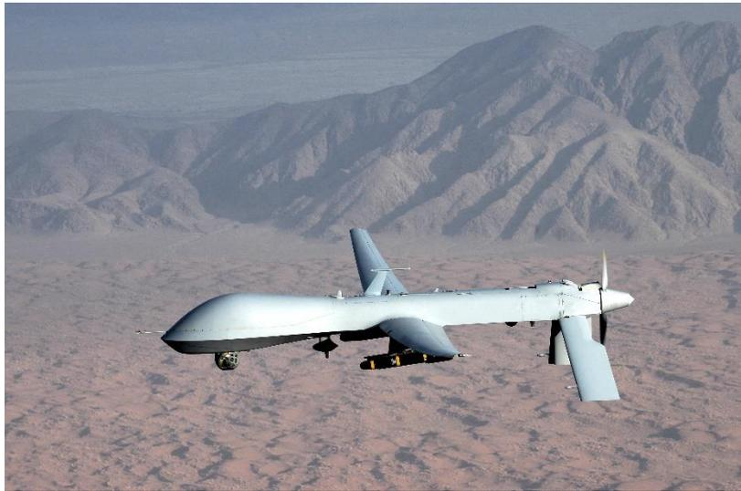
*Fig. 3. MQ-1 Predator Unmanned Aerial Vehicle (Wikimedia Commons 2011)*
